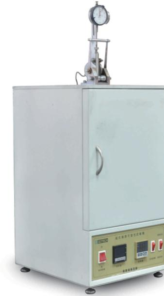
威氏可塑性试验机：测试生胶、塑炼胶、混炼胶及橡胶类的塑性值和复原值。
