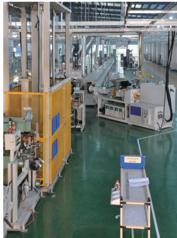
密封条五复合生产线
