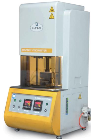
门尼粘度仪：用于测定生胶或混炼胶的门尼粘度值、焦烧时间。
