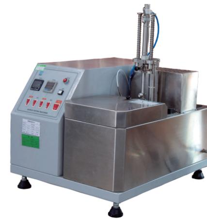
脆化试验机：检测橡胶低温脆性
