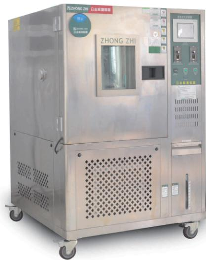
臭氧老化试验箱：检测橡胶、塑料臭老化性能
