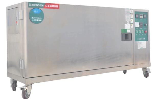
紫外光耐候试验机：检测橡胶、塑料的紫外线耐候性
